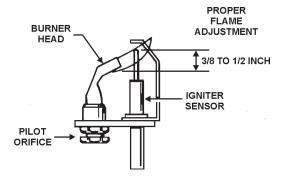
PILOT BURNER USED ON I.I.D. SYSTEMS
